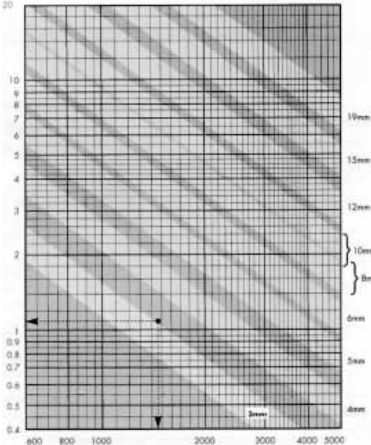
**PRESIÓN DE DISEÑO DE VIENTO (N/m<sup>2</sup>)**
